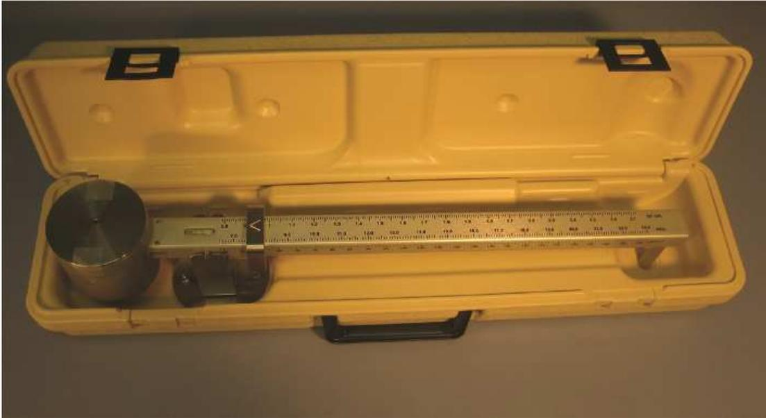
Mit der Spülungswaage kann das spezifische Gewicht (Dichte) der Bohrspülung gemessen werden.
