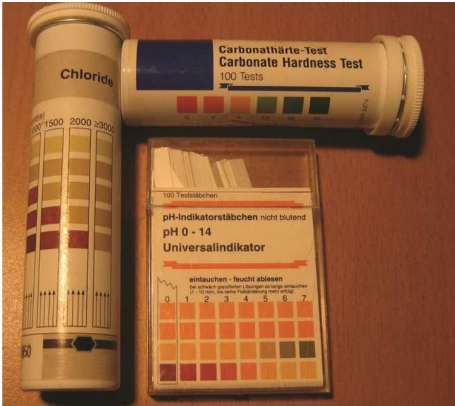
Die gebräuchlichen Papierteststreifen zur Messung des pH-Wertes, der Wasserhärte und des Chloridgehaltes dienen in erster Linie zur Prüfung des für das Herstellen der Bohrspülung verwendeten Wassers.
