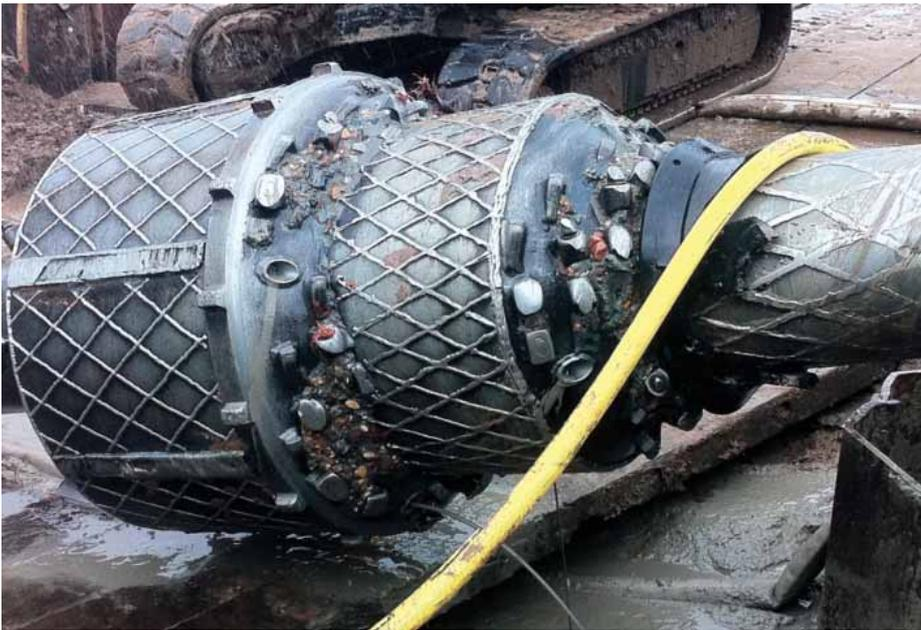
Kohäsiver Ton mit Kieseinlagerung am Räumler.
